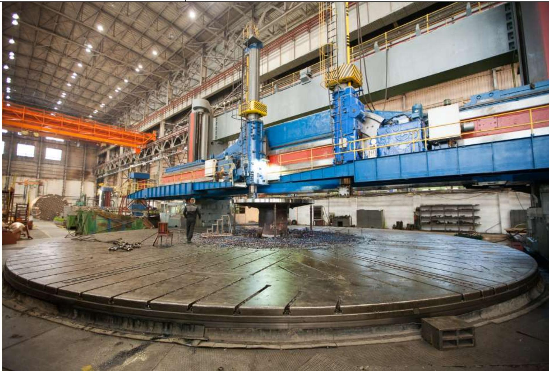
Токарно-карусельный станок с ЧПУ, SC-100/125-CNC
